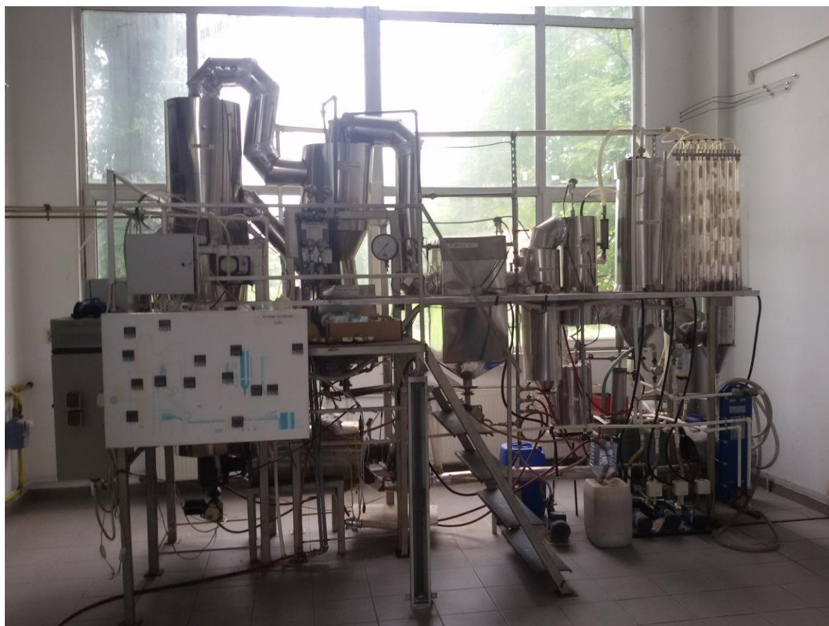
Figura 1. Tehnologie de Ardere în Strat Fluidizat Circulant cu captare CO 2 prin absorbție chimică
